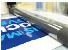
**CONÇU POUR LA LAMINATION À FROID** d'impressions numériques et de panneaux, à l'aide d'un film sensible à la pression, directement à partir d'une bobine ou feuille à feuille pour un minimum de gâche. Rouleau chauffant additionnel en option.
