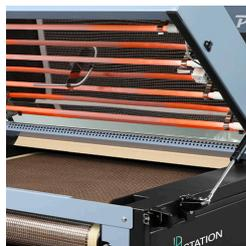
Système de chauffe par tube infrarouge
