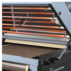
Système de chauffe par tube infrarouge
