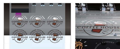
Les motifs sont imprimés sur un film adhésif spécial, auquel est automatiquement appliquée une feuille d'application.
