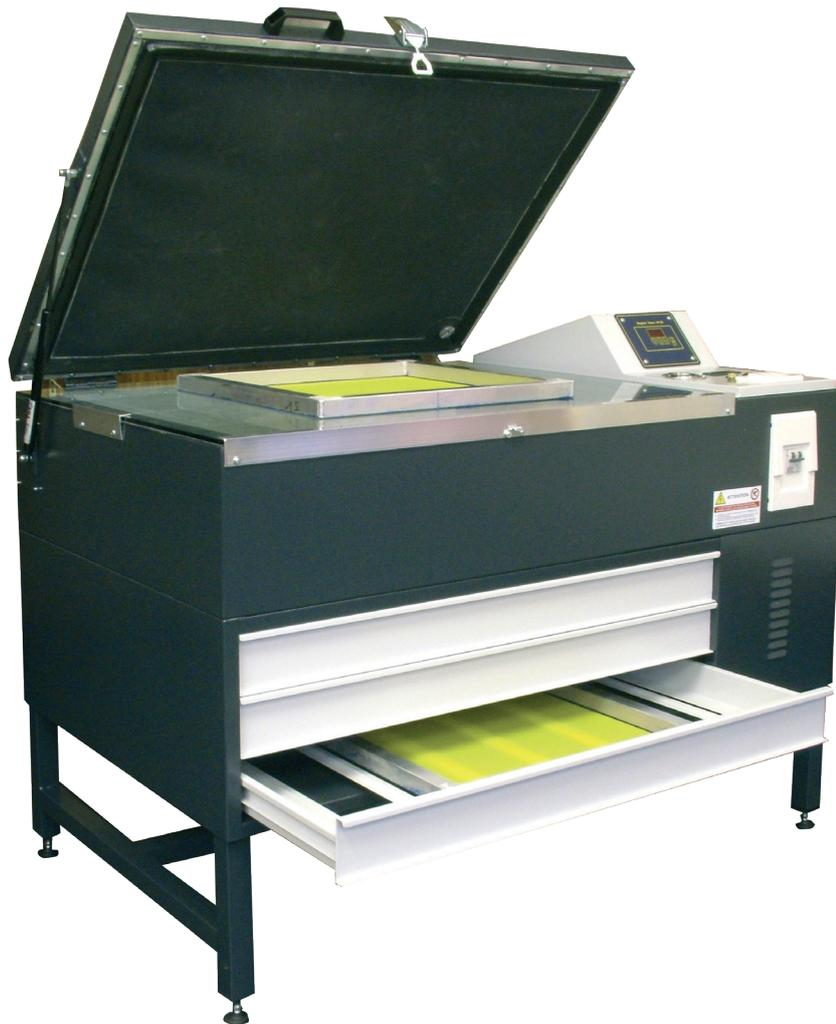
Le **Combinétuve d'établi** est constitué d'un châssis pneumatique avec insolation et d'une étuve.
