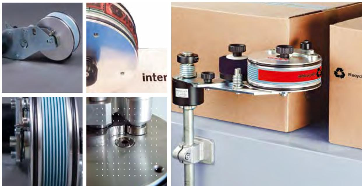
**Marqueur rotatif automatique Rollerpack**, marquant automatiquement un texte, un code, une référence, un logo sur le côté (droit ou gauche), le dessus d'emballages en mouvement sur convoyeur, en sortie de conditionnement, etc...
