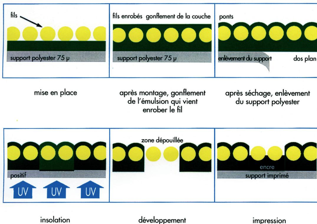
Son utilisation est simple, rapide et propre. Le montage s'effectue par capillarité après mouillage à l'eau des 2 faces de l'écran.
