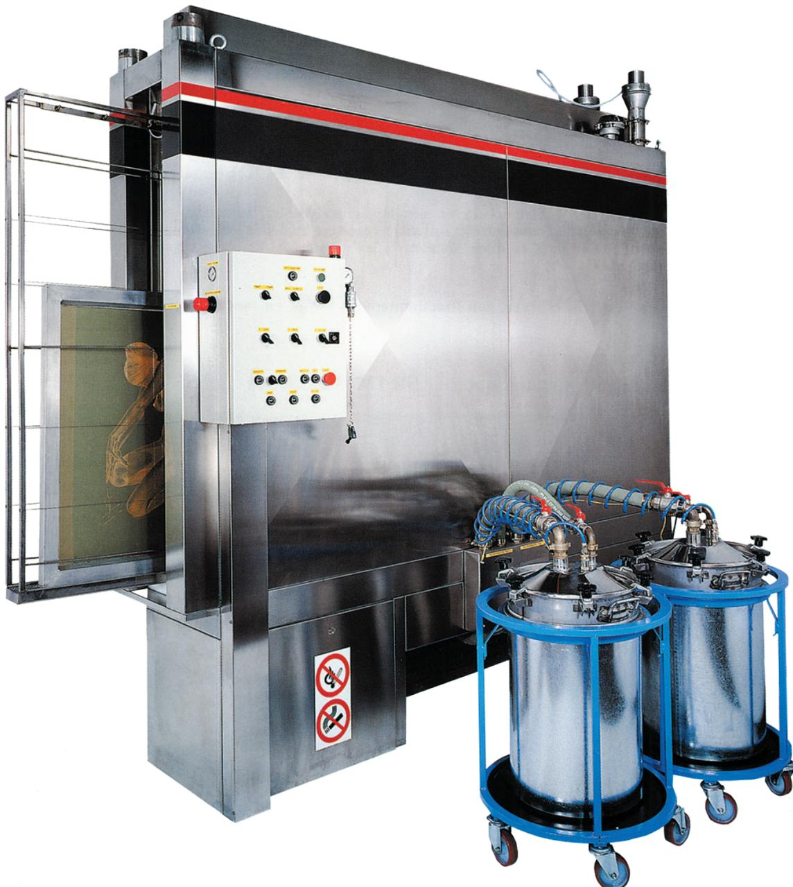
Le **Laveur automatique pneumatique** est entièrement réalisé en acier inoxydable.
