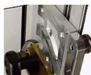
Les outils de coupe et de rainurage s'interchange en quelques secondes à l'aide d'une seule vis à main
