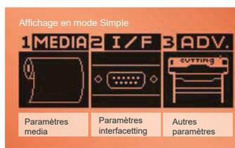
Deux menus de sélection, simple ou normal, sont disponibles et peuvent être choisis par l'opérateur comme il le souhaite. Dans le mode menu simple, les conditions de découpe mémorisées correspondant au type de support sélectionné sont utilisées.
